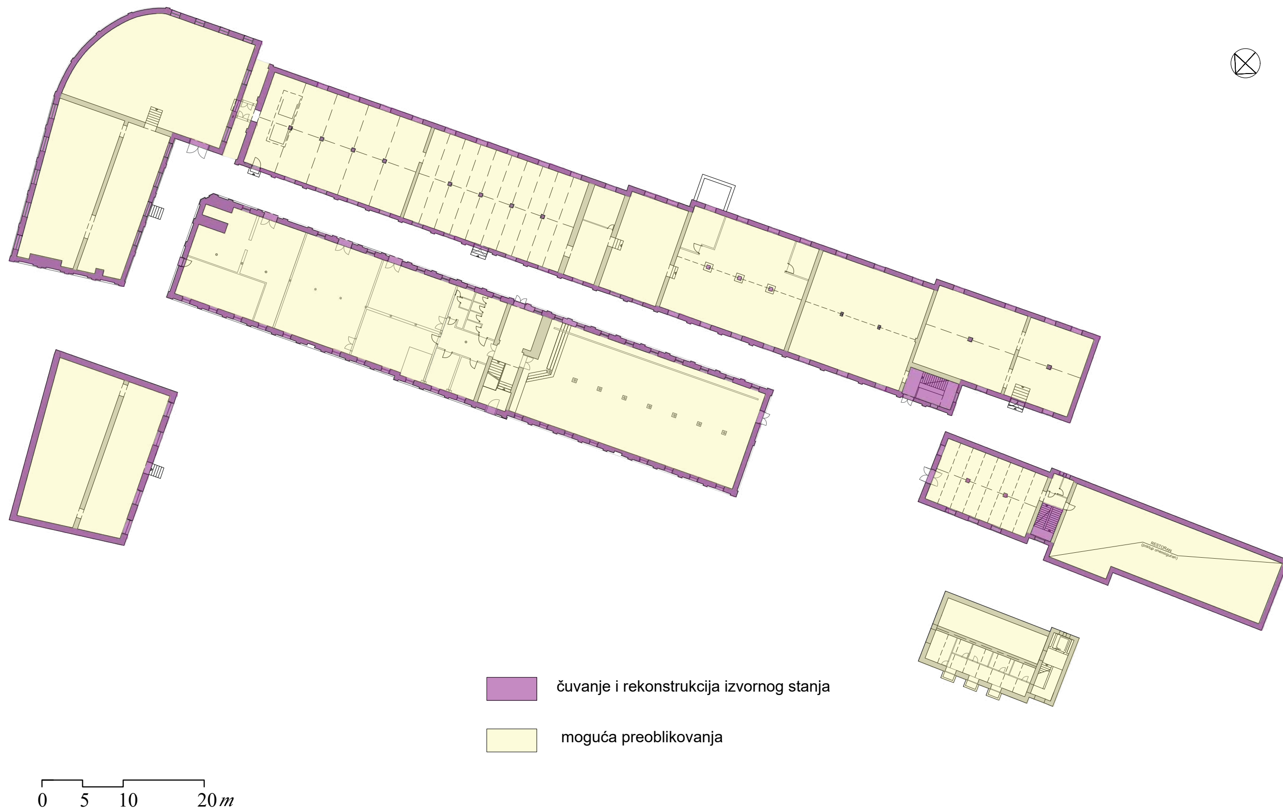
Tlocrt prizemlja s naznačenim smjernicama za obnovu
